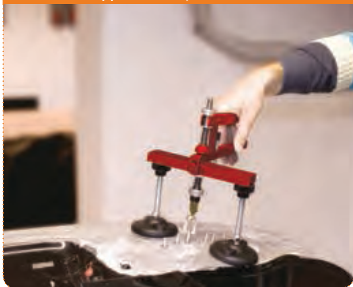
Per riprazioni su lamierati in alluminio / For dent repair on aluminium panels
