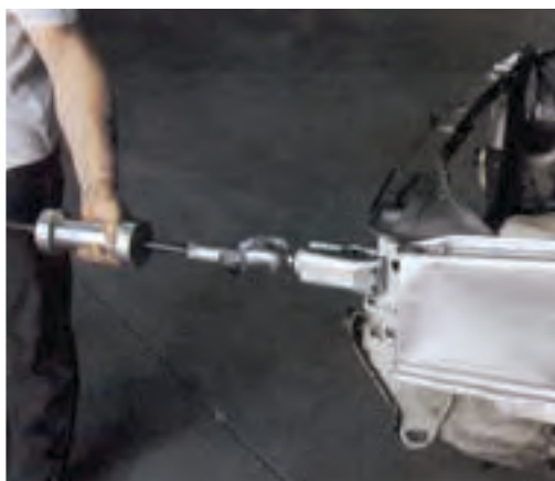
Art. 202 | Morsetto autobloccante speciale Special self locking pull clamp
