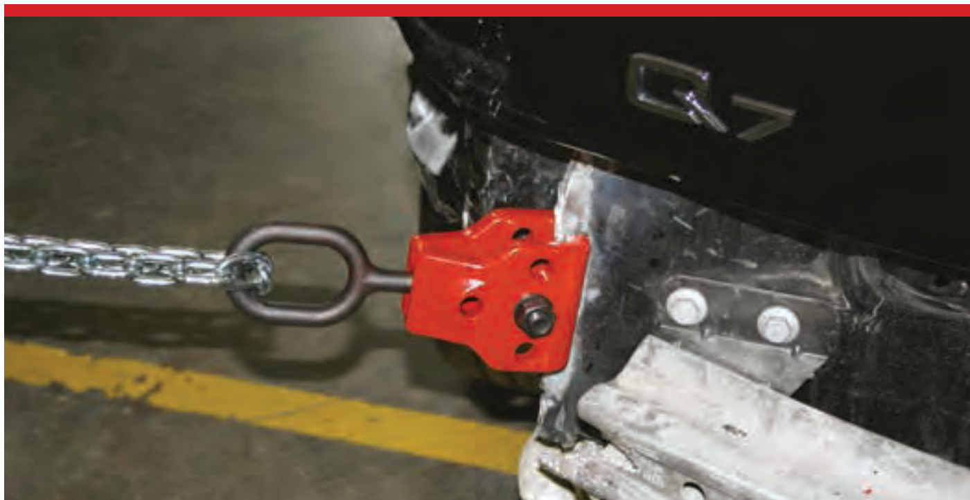
Art. 131 Morsetto universale 100 mm. Ganasce dentate intercambiabili.
